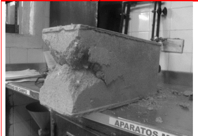
Figura 5. Falla diagonal de corte, típica en bloques de baja y media resistencia. Fuente: Elaboración propia.
