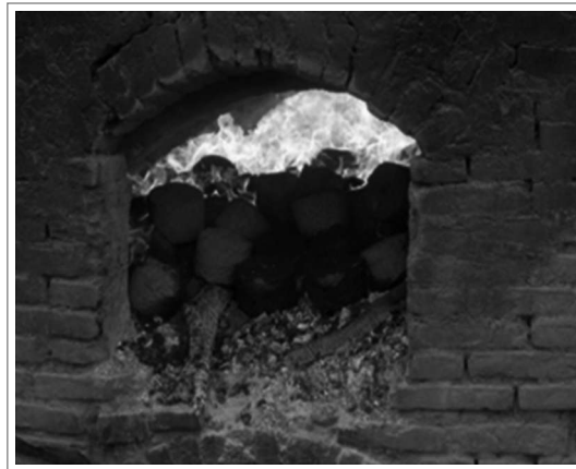
Figura 4. Detalle del hogar de fuego del horno, sustitución de la leña por el biocombustible BSC Figure 4. Furnace combustion detail, wood substitution by biofuel BSC
