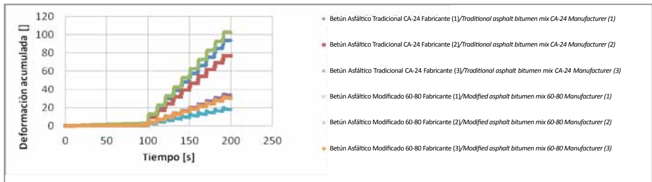
Figura 4. Resultados de Fluencia y Recuperación (Creep and Recovery) betunes tradicionales y modificados.
