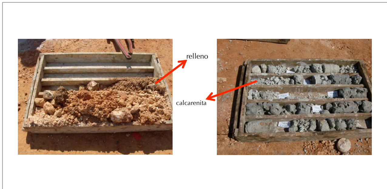
Figura 1. Fotos de las muestras del relleno y la calcarenita obtenidas durante la exploración
