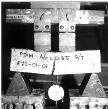
Figura 10. Ensaye a flexión para obtener el módulo de ruptura de especímenes de CRFN
