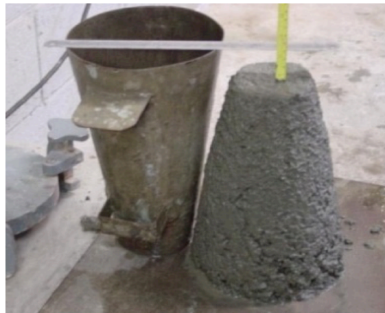
Figura 3. Evaluación del ensayo de asentamiento
